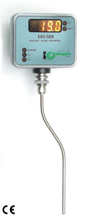
1 Vaina plegable con un radio mínimo de curvatura de 3 veces el diámetro (excepto los 30 mm de la punta sensible)
