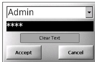
Desde este dialogo seleccionar el usuario a utilizar e introducir su clave. El botón "Clear Text" muestra la clave introducida. Si la clave introducida es errónea se mostrará un mensaje de error.
