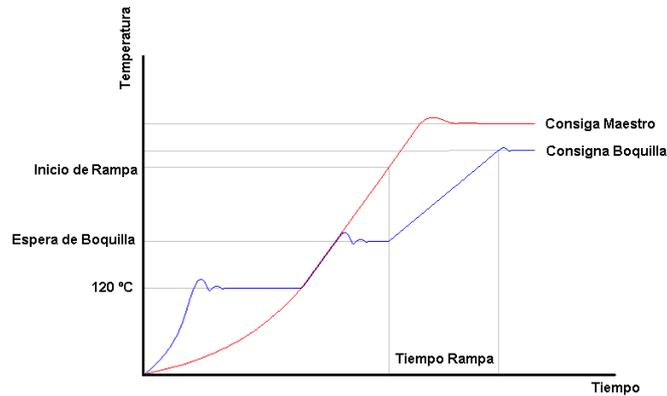
En el ejemplo, la línea roja corresponde a la evolución de la temperatura del controlador maestro, y la azul a la de una boquilla
