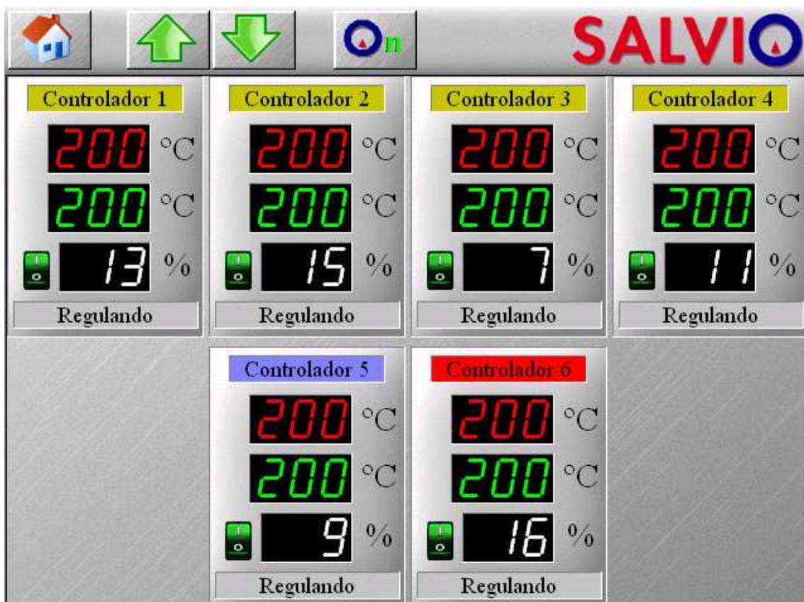
Cada uno de los bloques de control, además de mostrar información sobre la zona, permite reconfigurar los parámetros principales del controlador. Cada uno de estos bloques está formado por los siguientes elementos.
